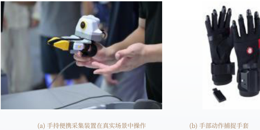
图 4 便携采集与动作捕捉两类无本体数据获取方式
