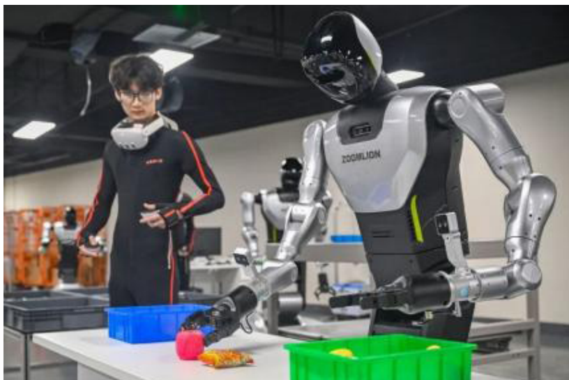
图2 遥操作员通过穿戴式主端设备远程控制机器人完成抓取分拣
